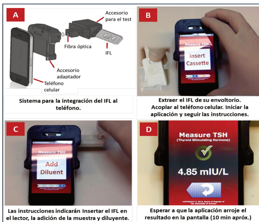
Figura 6: Esquema del sistema de acoplamiento de un IFL al teléfono celular. A) Partes que lo componen. B, C y D) Ejemplo de un test de medición de la hormona estimulante de la Tiroide (TSH) integrado al celular. Imagen adaptada de You et al., 2013 (You et al., 2013).
