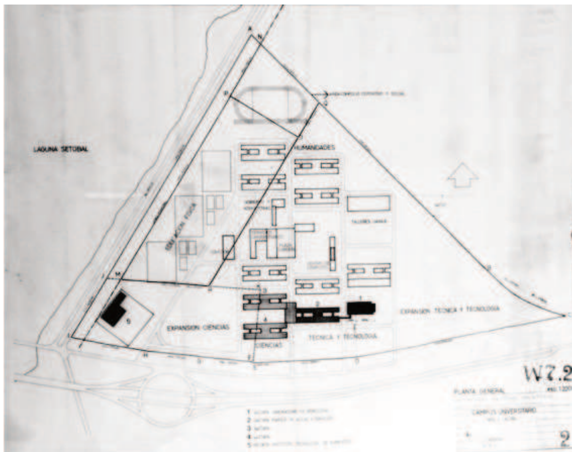
Planta general CU (plano W7.2-2, Esc. 1:2000, 1974). Ref.: 1. 1ª Etapa Lab. de Hidrología; 2. 2ª Etapa Parque de Aulas y Servicios; 3. 3ª Etapa; 4. 4ª Etapa; 5. Recinto ITA. En negro: etapas realizadas. En gris: a construir / ADCU-UNL
