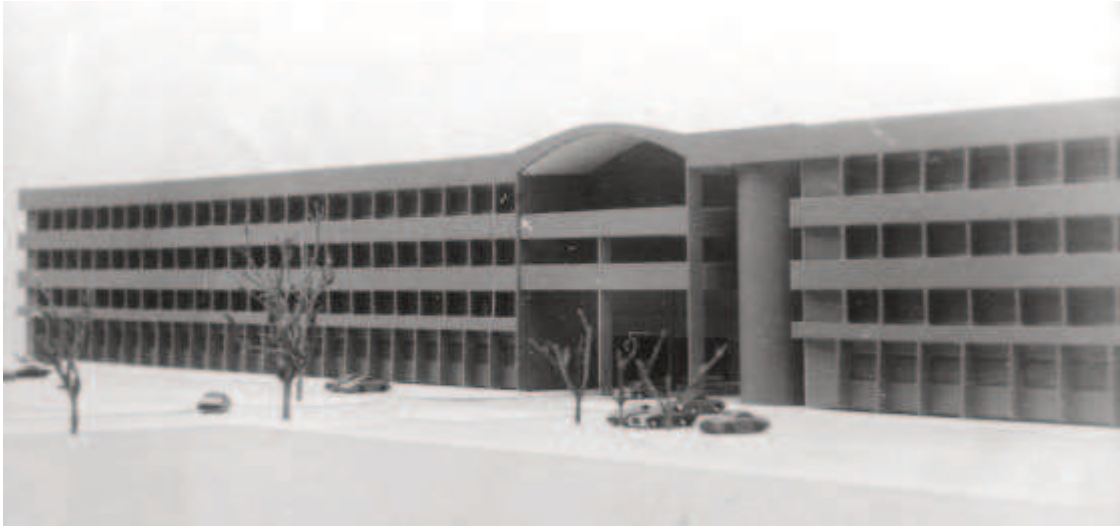
Maqueta, vista desde el sur, primer proyecto. Se aprecian sombras arrojadas por parasoles y cubierta del núcleo central / ADCU–UNL
