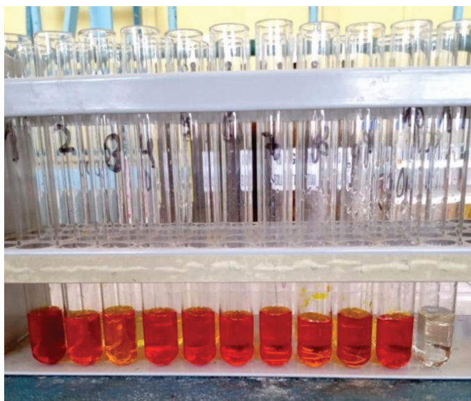
Figura 2: sensor utilizado en muestras de \text{NO}_2^- a distintos pHs
