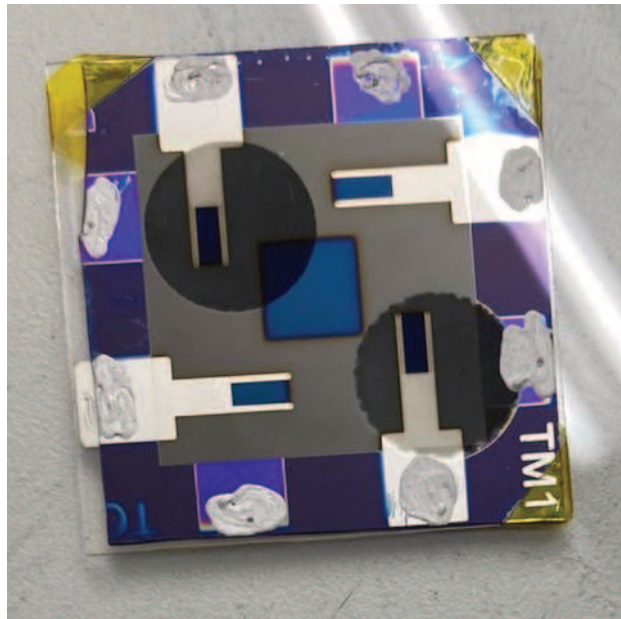
Figura 6.3: Fotografía de celdas solares de perovskita evaporadas sobre silicio plano y sobre silicio macroporoso.
