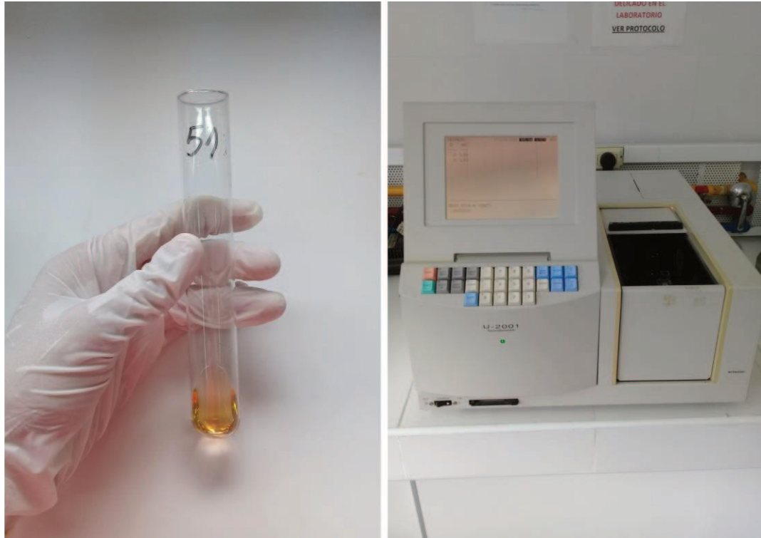
Figura 8: Determinación de carbohidratos no estructurales solubles. Izquierda: Coloración de la reacción entre el extracto, agua destilada, fenol y ácido sulfúrico concentrado. Derecha: Lectura en espectrofotómetro
