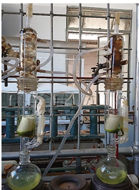
Figura 2.3. Extracción de compuestos fenólicos por Soxhlet
