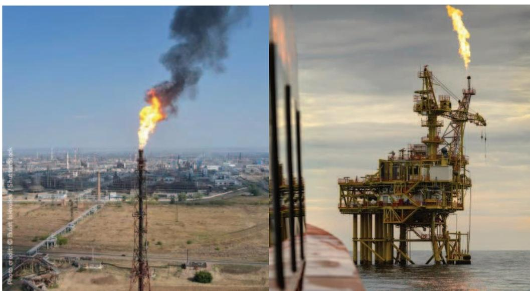
Figura 5.1: Venteos con quema de gas en chimeneas de quema instaladas en tierra y en áreas “off shore”
