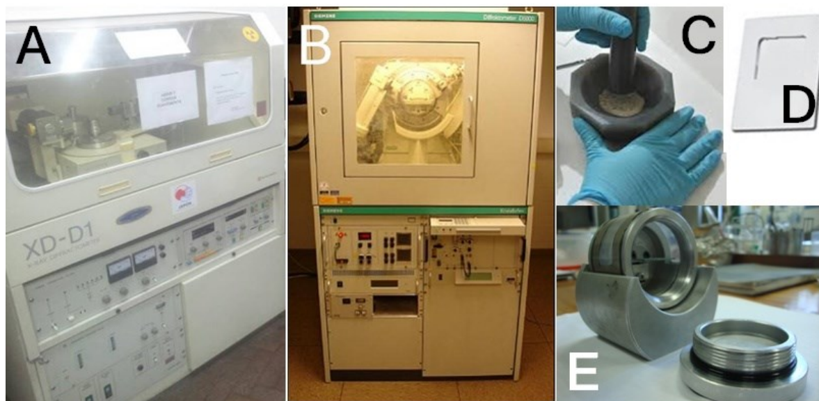
Figura 3.1. Difractómetros: A) Equipo Shimadzu XD-D1, B) Equipo Philips PW 1710/01 Instruments, C) Mortero y pistón para la molienda de los polvos, D) Portamuestras del equipo Shimadzu y E) Cámara y portamuestras del equipo Philips para llevar a cabo el análisis en atmósfera controlada.
