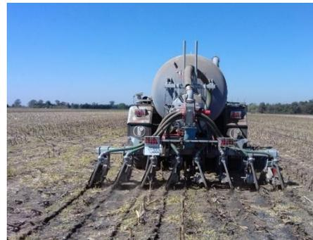
Figura 2: Inyección de desechos SLP en el suelo
