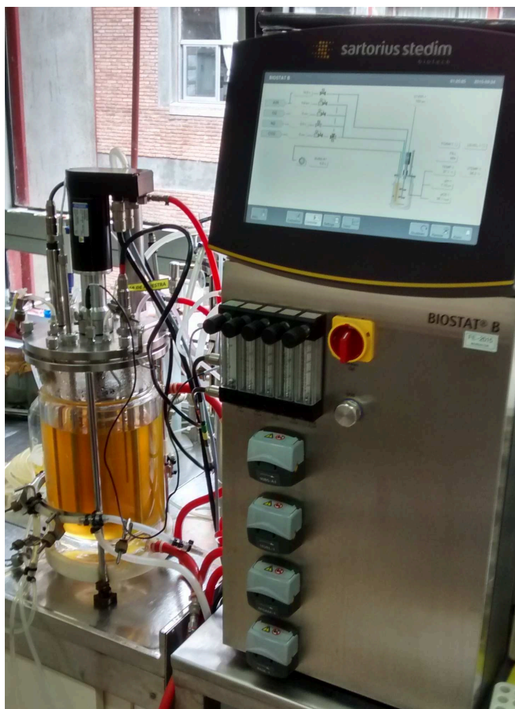
Figura 66. Producción de RV-VLPs en biorreactor de 4,5 L de volumen de trabajo. El cultivo fue operado de modo continuo, utilizando un filtro de tipo spin para llevar a cabo la retención celular. El equipo posee toda la periferia necesaria para realizar un control on-line de la temperatura, pO_2 , pH y velocidad de agitación, como así también el caudal de perfusión.
