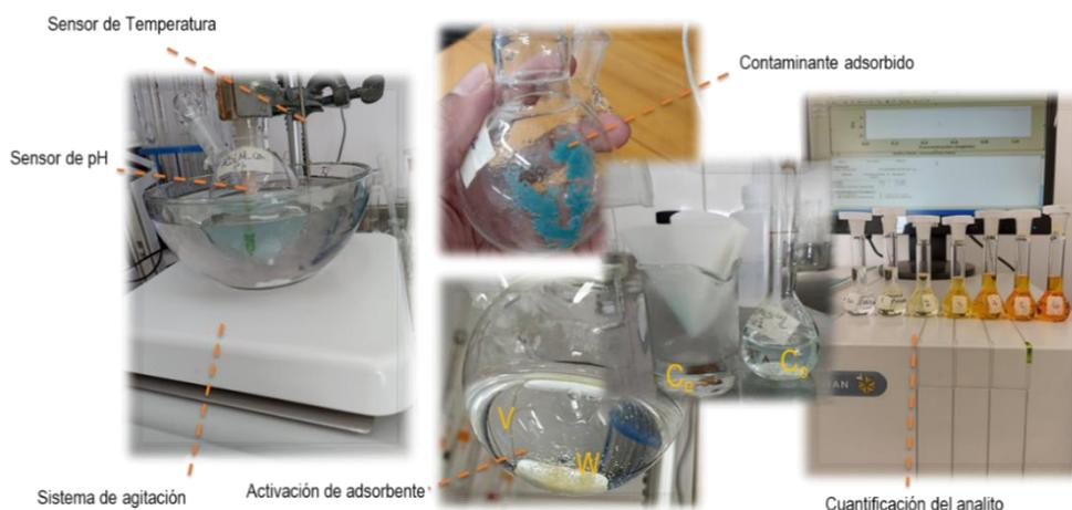
Figura 2.10. Sistema de adsorción y cuantificación de adsorbatos.
