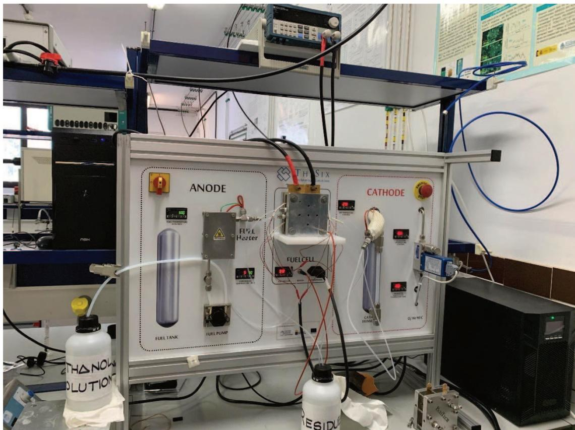
**Figura 2.25.** DEFC prototipo ensamblada, conectada y en operación en la estación de prueba.
