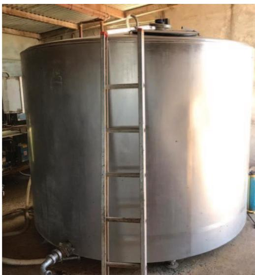
Figura III.5: Tanque de almacenamiento de leche previo al lavado (vista frontal).
