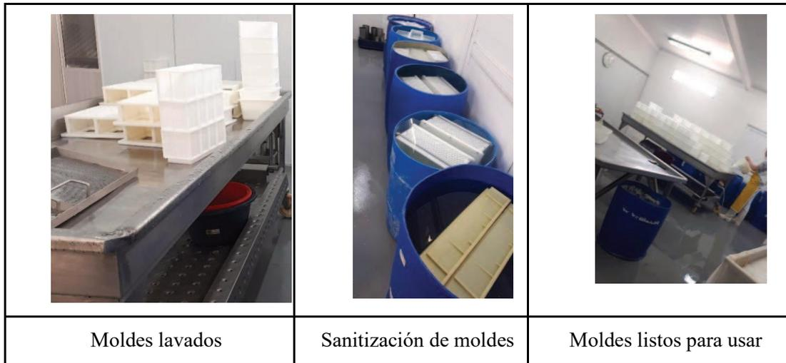
Figura I.68: Estacionamiento de elementos lavados- CASO A.
