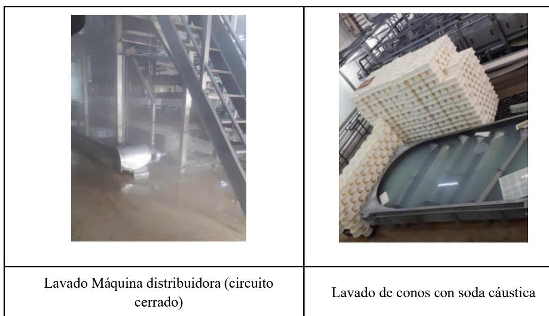
Figura I.71: Lavado máquina distribuidora y sus elementos- CASO B.
