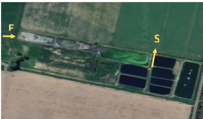
Figura II. 1.: Vista satelital de la planta de tratamiento de la Industria B. “E” indica la entrada del efluente al sistema de tratamiento y “S” la salida del efluente tratado.
