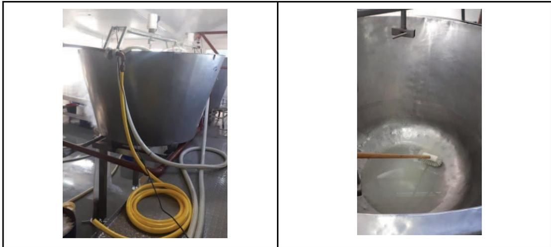
Figura I.64: Sistema de limpieza de tinas- CASO A.
