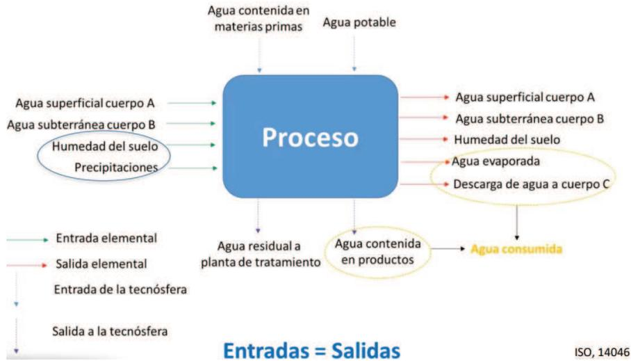
Figura V.1: Balance hídrico de un proceso (Suppen, 2018).
