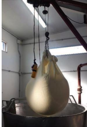
Figura I.40: Extracción de masa mediante elevador- CASO A.
