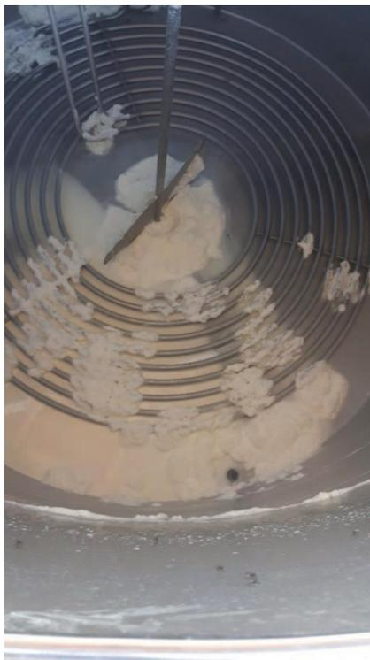
Figura III.4: Tanque de almacenamiento de leche previo al lavado (vista superior).
