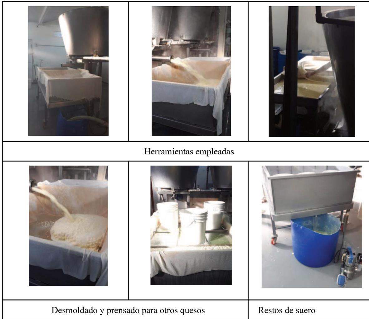
Figura I.41: Herramientas para descarga de masa y prensado- CASO A.
