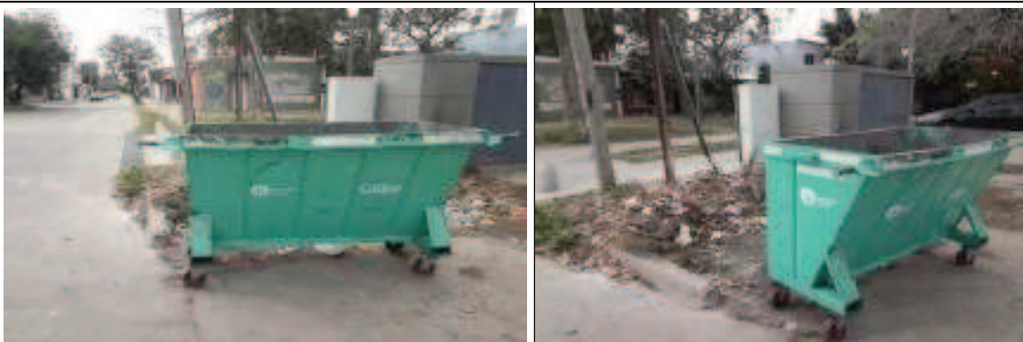
Figura 6.25: Se observa contenedor metálico ubicado en rotonda sobre calle Marta Samathan entre las calles Julio Busaniche y Rosario Vera Peñaloza intersección de calle Celia Ortiz. Poseen ruedas y una capacidad de 1000 litros. Servicio a torres 13 y 14.
