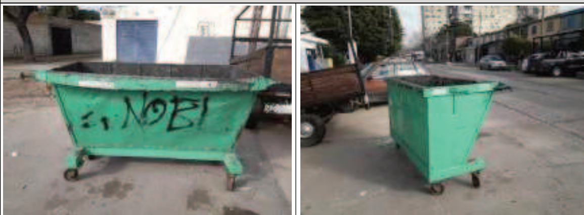
Figura 6.34: Se observa contenedor metálico ubicado sobre calle Greca frente al tanque de agua. Poseen ruedas y una capacidad de 1000 litros. Servicio a torres 3 y duplex sobre calle Greca. Fuente: registros propios del autor, 2024.
