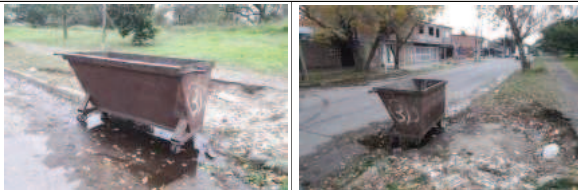
Figura 6.21: Se observa contenedor metálico ubicado sobre calle Guillermo Estevez e intersección de calle peatonal Pablo Vrillaud. Poseen ruedas y una capacidad de 1000 litros. Servicio a manzanas 3 y 4. Fuente: registros propios del autor, 2024.
