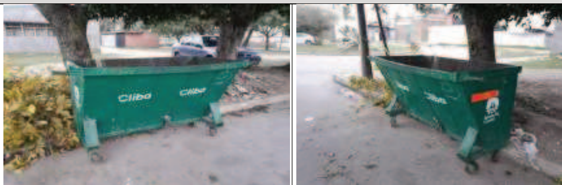
Figura 6.36: Se observa contenedor metálico ubicado sobre rotonda de calle Jose Babini. Poseen ruedas y una capacidad de 1000 litros. Servicio a manzanas 2 y 3. 2024
