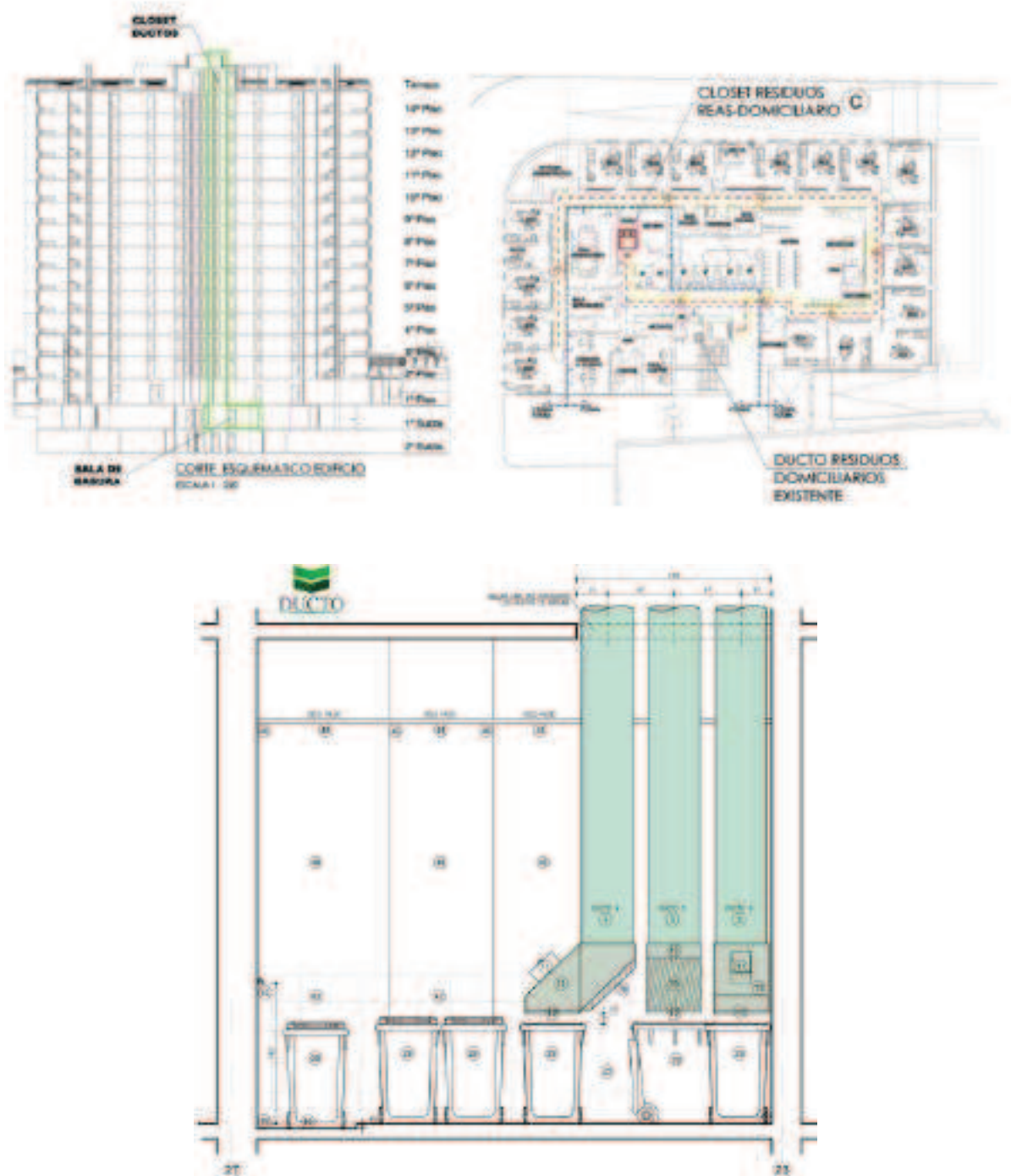
Figura 8.20: Vista de sistema de ductos para torres. Fuente Empresa ducto proyectos, Chile, 2024
