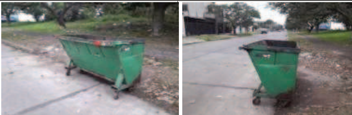
Figura 6.22: Se observa contenedor metálico ubicado sobre calle Guillermo Estevez e intersección de calle peatonal A. Bioy Casares. Poseen ruedas y una capacidad de 1000 litros. Servicio a manzanas 1 y 2. Fuente: registros propios del autor, 2024.
