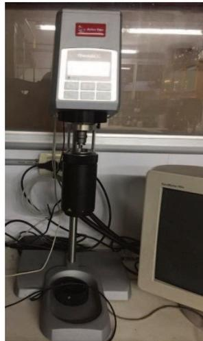
**Figura 37.** Viscosímetro rotacional, Modelo Rheolab QC, Marca Anton Par.
