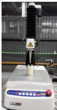
**Figura 38.** Texturómetro TA.XT Plus Stable Microsystems con sonda P/10.
