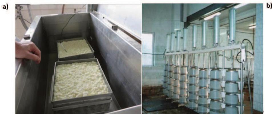
**Figura 9.** a) Quesos blandos: leve prensado de la masa por apilamiento de dos (o tres) moldes por superposición de moldes. b) Quesos duros o semiduros: prensado intenso mediante el empleo de prensa.
