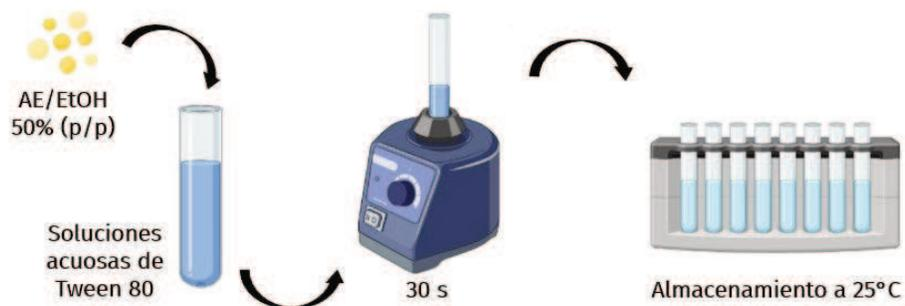
**Figura 7.** Esquema de obtención de SMs-1.
