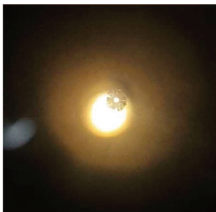
Figura 3.8. Imagen de microscopio, cobre (0) electrodepositado sobre microcátodo de oro.
