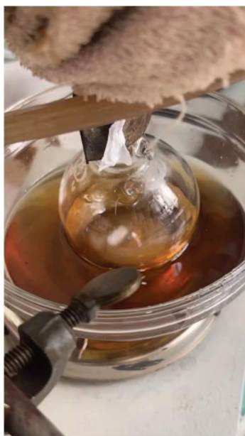
Figura 2.12: Imagen de reactor para la azidación de 6-mono- O -( p -toluenosulfonil)-β-CD.
