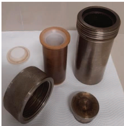
Figura 10. Autoclave utilizada para síntesis solvotérmica de Cu-MOFs mediante calentamiento en estufa convencional.
