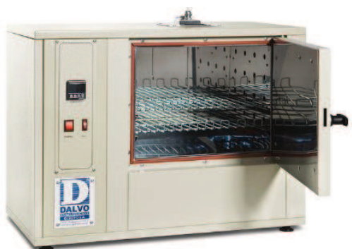
Figura 12. Estufa marca DALVO modelo Sp343-PID utilizada en la síntesis solvotérmica y secado de MOFs
