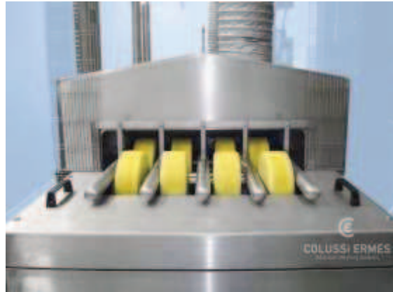
Figura 6: Imagen de una lavadora industrial de quesos.
