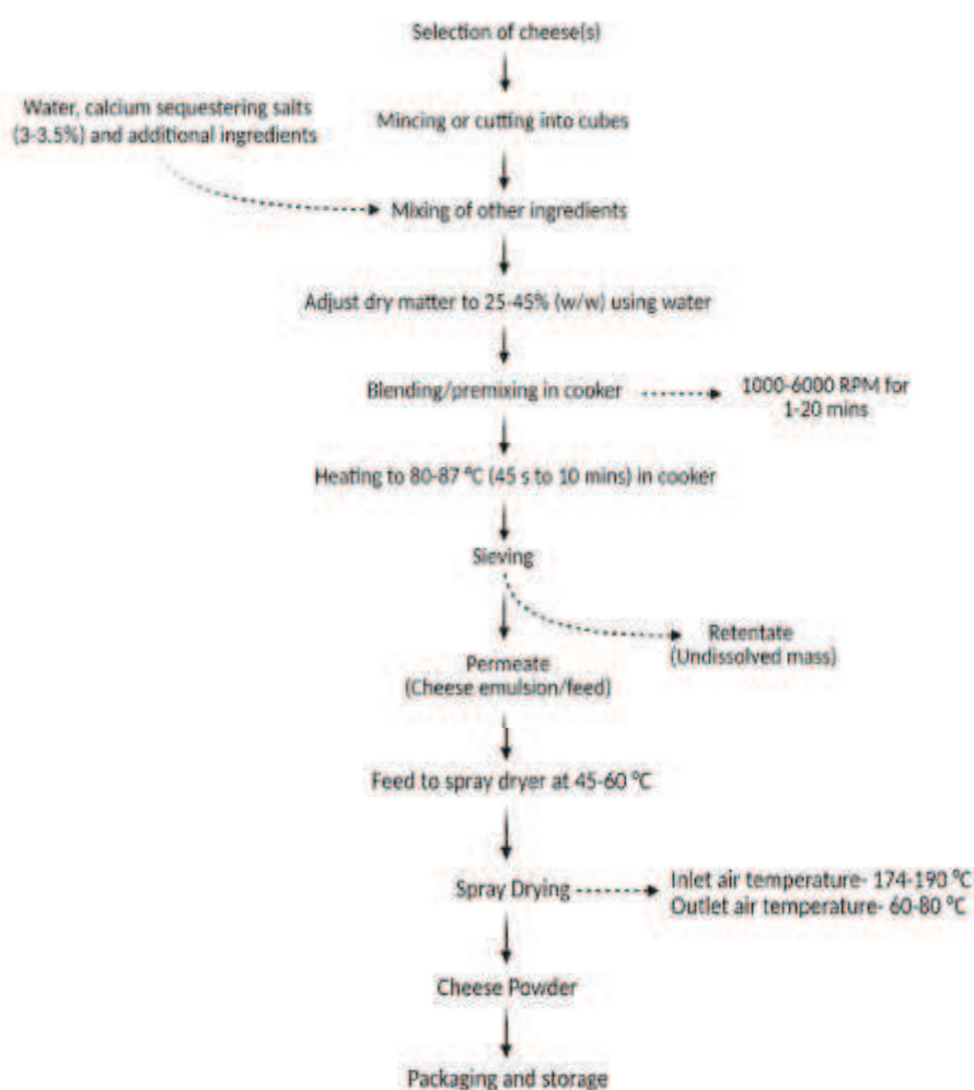
Figura 4: Esquema de producción de los quesos en polvo.
