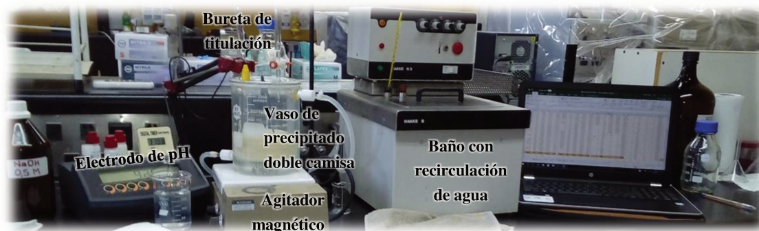
Figura 10. Sistema experimental empleado para la hidrólisis enzimática del WPC-80.
