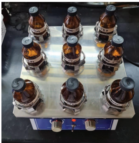
Figura 24. Agitador orbital empleado para los ensayos de adsorción, junto con los frascos que contenían la biomezcla en contacto con la solución de plaguicida.
