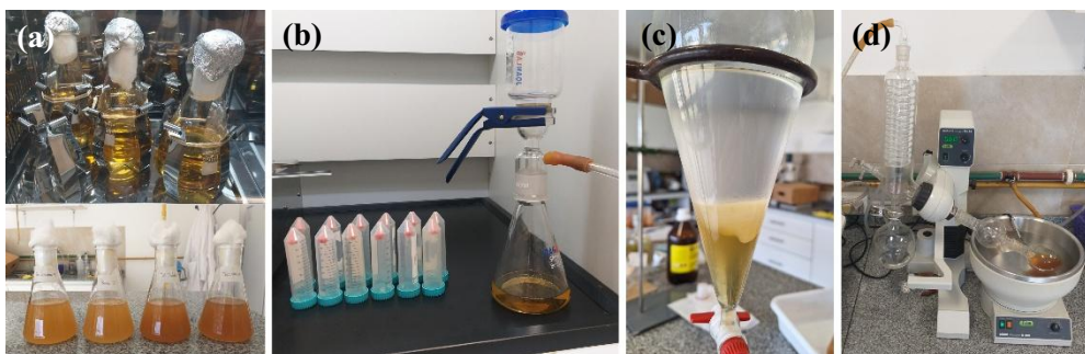
Figura 25. Obtención de extractos fijos del metabolismo de B. licheniformis y P. mendocina : (a) incubación de bacterias en medio LB líquido; (b) filtración al vacío para separar el pellet del medio de cultivo; (c) extracción L-L con AcOEt del medio de cultivo; y (d) separación del solvente y del extracto puro con rotavapor.
