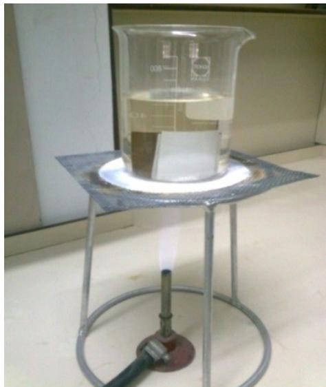
**Fig. 4. 12.** Representación del ensayo de resistencia al agua hirviendo.
