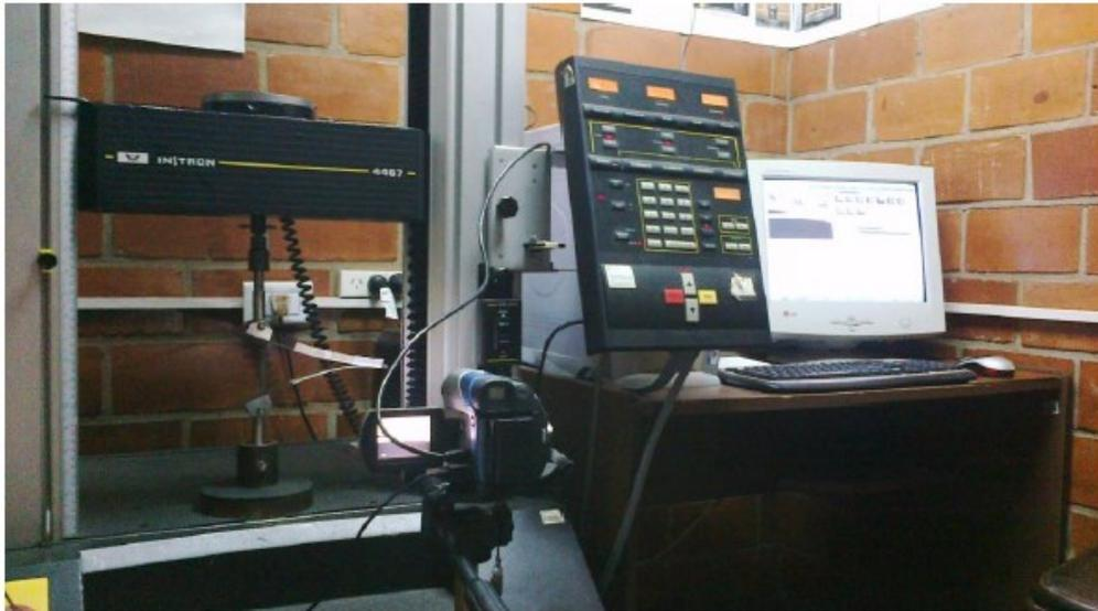
**Fig. 4. 8.** Configuración del ensayo de delaminación.
