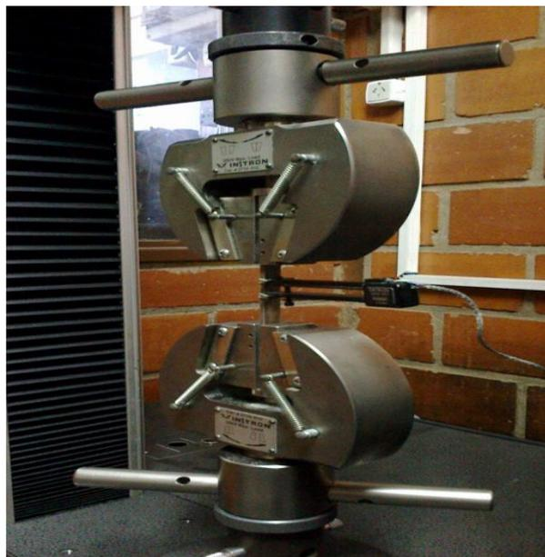
**Fig. 4. 2.** Máquina de ensayos de tracción.
