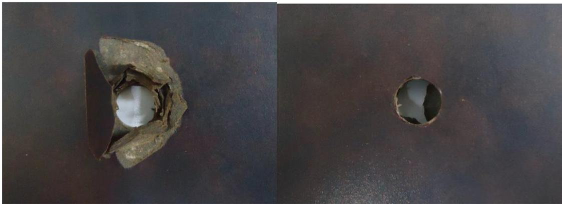
**Fig. 4. 19.** Fotografías de una muestra KPFL luego del impacto. (a) Superficie traccionada. (b) Superficie en contacto con el dardo.
