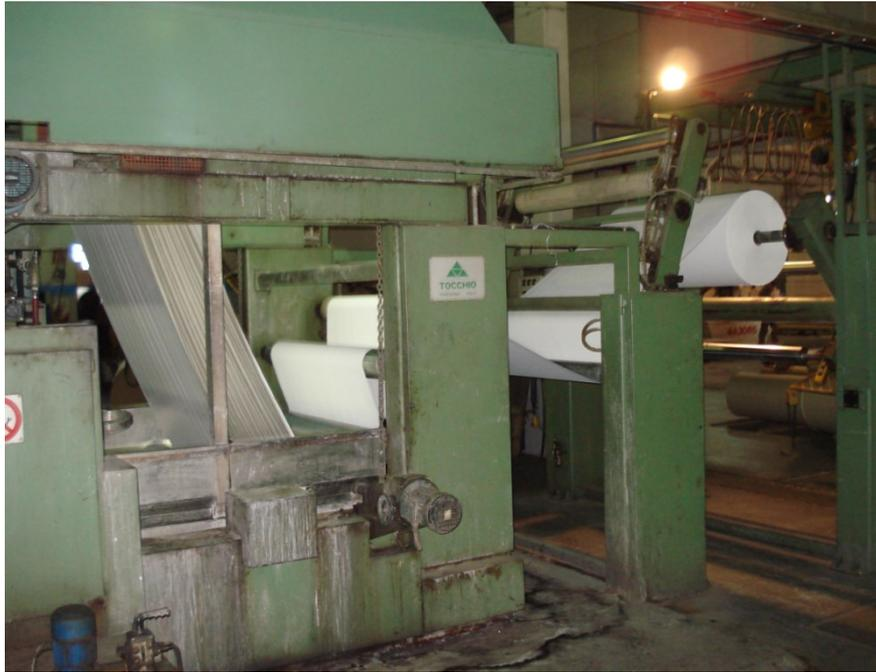
**Fig. 3. 5.** Primer cuerpo de la impregnadora marca TOCCHIO (Italia) empleada para la impregnación de papeles destinados a la producción de laminados decorativos marca Karikal.
