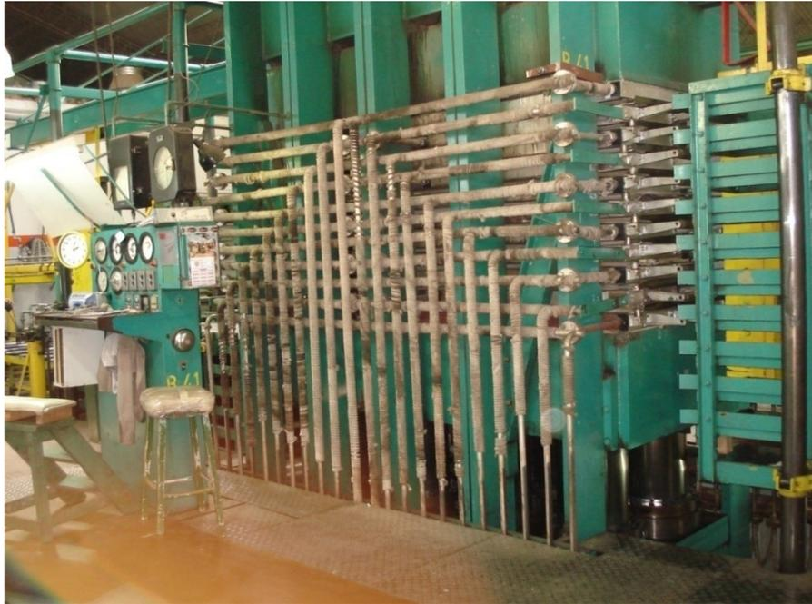
**Fig. 3. 6.** Prensa multiapertura marca FJELLMAN (Alemania) empleada para la producción de laminados decorativos de alta presión marca Karikal.
