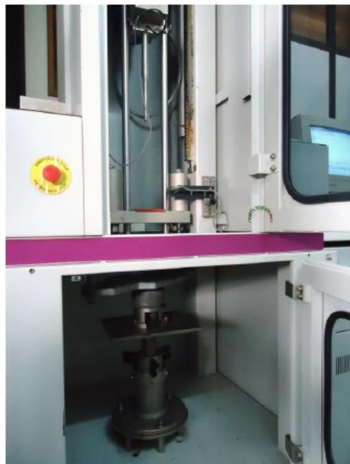
**Fig. 4. 4.** Máquina de ensayos Fractovis CEAST 6789.
