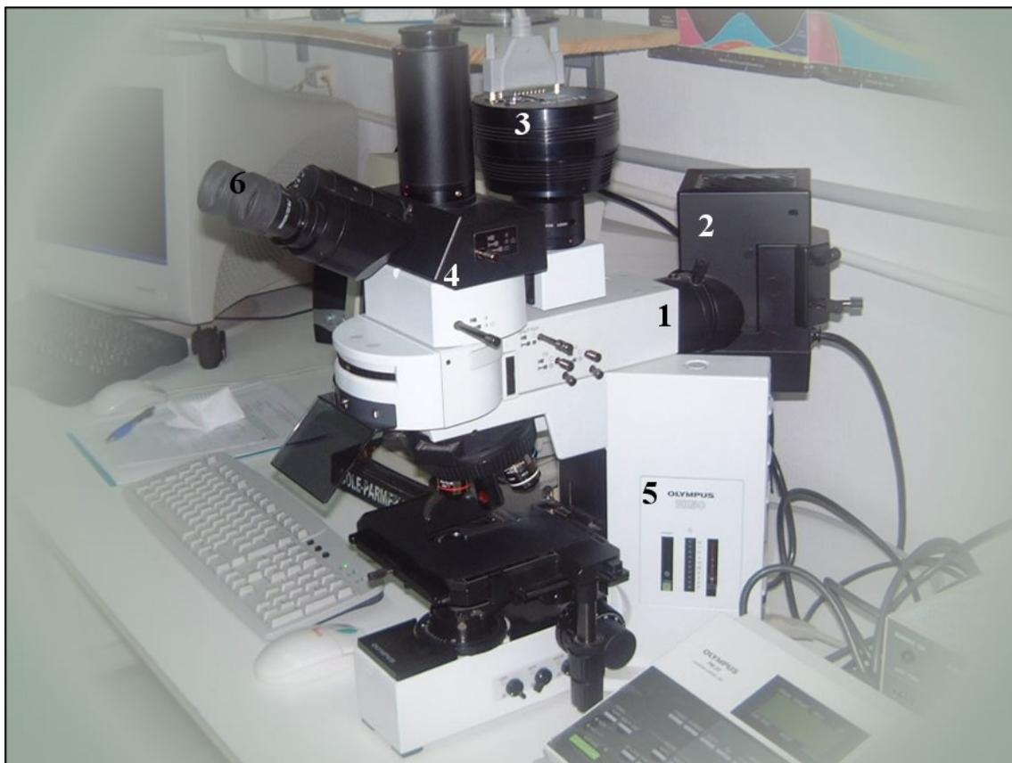
**Figura 12. Microscopio de epifluorescencia Olympus BX-50.** (1) Lámpara halógena. (2) Lámpara de mercurio. (3) Cámara CDD. (4) torreta de filtros. (5) modulo electrónico. (6) PC de control.
