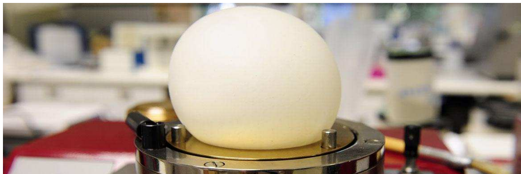
FIGURA III.53. Burbuja de masa en el alveógrafo.
