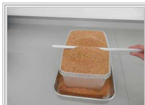
FIGURA III.58. Medición del volumen del pan mediante el desplazamiento de semillas.
