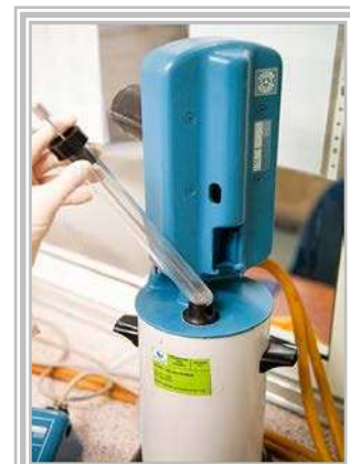
FIGURA III.48. Tubo viscosimétrico en el equipo de medición de Falling Number .
