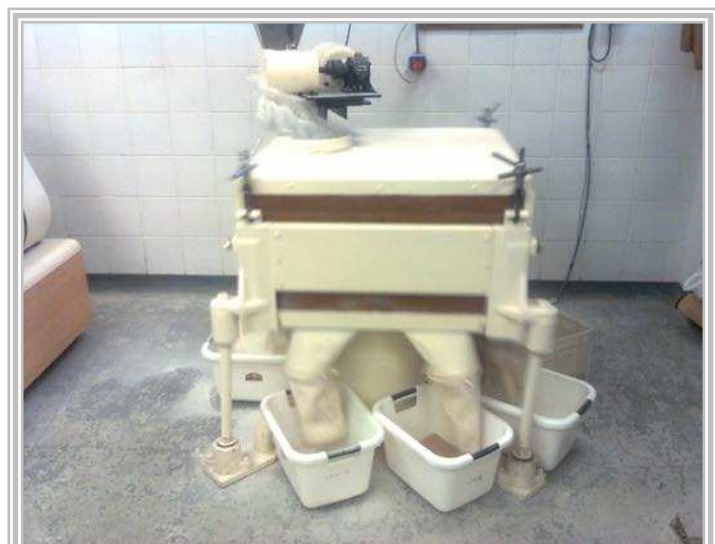
FIGURA III.44. Plansifter Buhler Rotostar Tipo MPAR –H.
