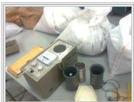
FIGURA III.40. Higrómetro DELVER Modelo HD 1000D.
