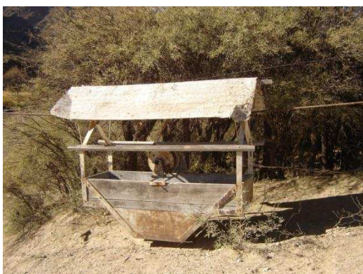
Figura 1. 18: Vagoneta de Aforo a cable carril (izquierda) – Molinete Hidrométrico empleado bajo condiciones de crecidas (derecha)
