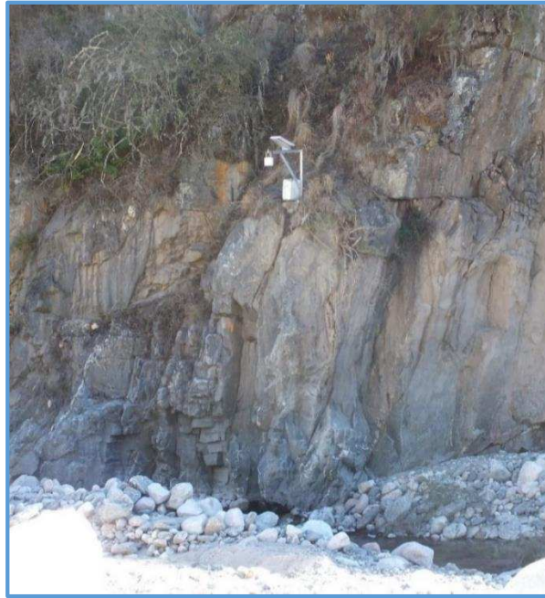
Figura 1. 12: Estación Pluviométrica telemétrica que conforma el Sistema de Alerta temprana para la Localidad del Rodeo – Departamento Ambato – Provincia de Catamarca
