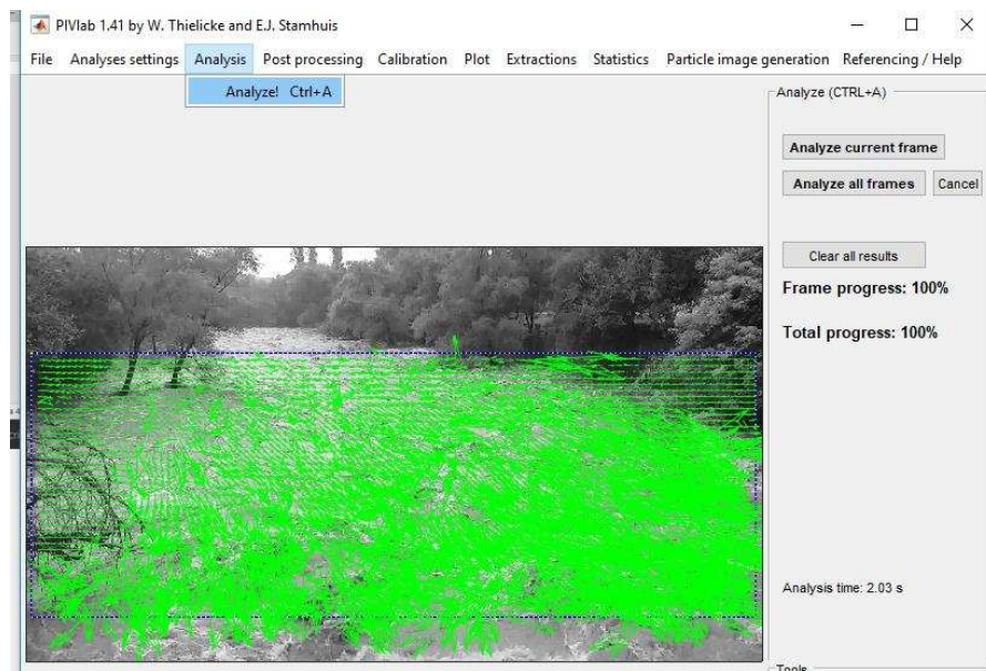
Figura 2. 8: Resultado de correspondencia de pares entre dos imágenes consecutivas mediante LSPIV.
