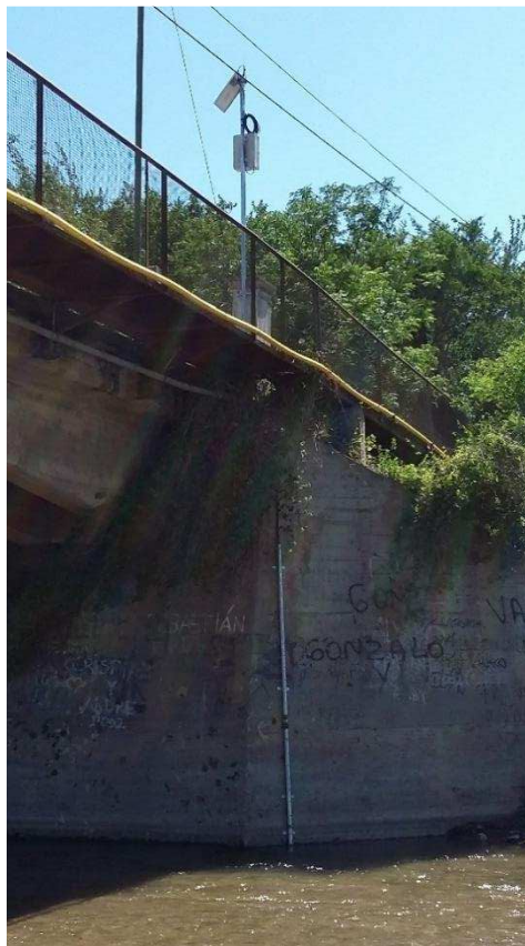
Figura 1. 14: Sensor de Nivel ubicado sobre el Río Paclín en la localidad de La Merced departamento Paclín
