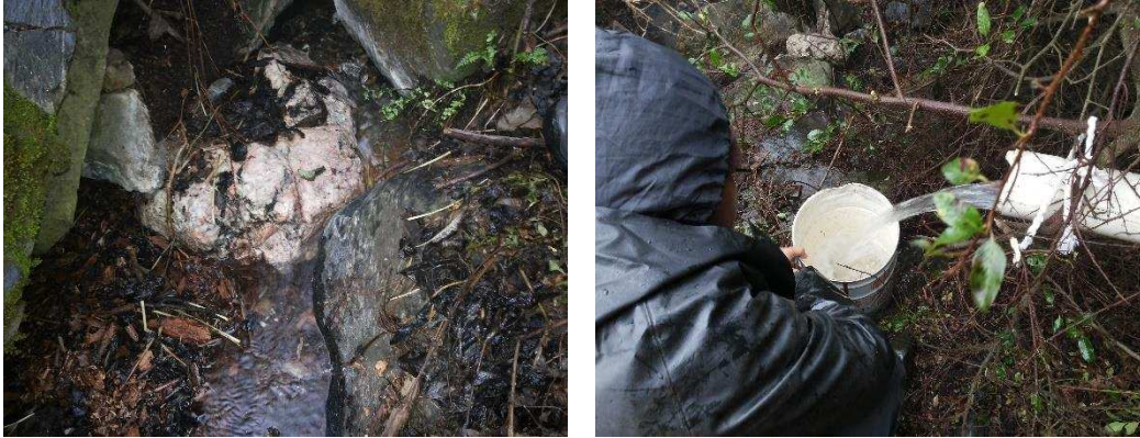
Figura 1. 16: Aforo Volumétrico sobre la vertiente El Sauco - Localidad de Rosario de Colana departamento Pomán, provincia de Catamarca
