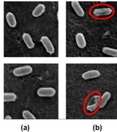
Figura 5. Imágenes SEM. Recubrimientos de TiO 2 con muestras de esporos: (a) sin irradiar, (b) luego de 7,5 h de irradiación.
