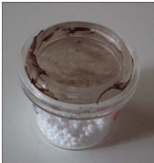
Figura 2.13: Recipiente con \text{CaCl}_2 y EPD humana utilizado para determinar la trasmisión de vapor de agua.
