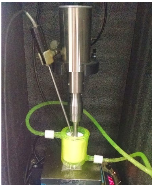
Figura 2.4: Equipamiento de ultrasonido utilizado para la preparación de las miniemulsiones.
