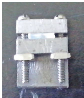
Figura 2.18: Mordaza empleada para sujetar la muestra y realizar el corte para observación de la superficie en AFM.
