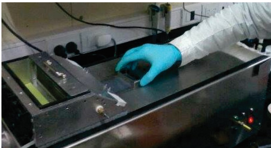
Figura 2.15: Equipo utilizado para la determinación visual de la MFFT.
