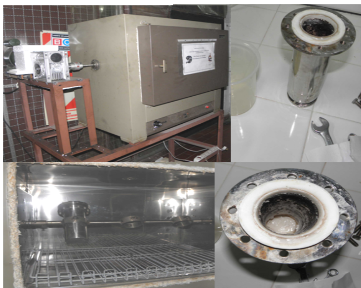
Figura IV-10 Estufa acondicionada para la rotación del reactor a 60 rpm y temperaturas entre 50°C y 300°C (Izq). Reactor de síntesis con camisa interior en teflón (Der).
