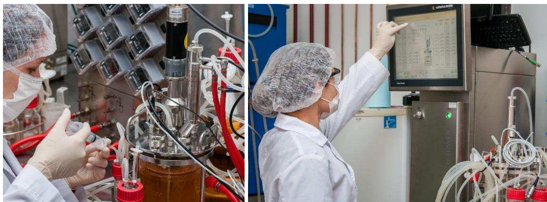
Figura 13. Cultivo de células CHO-K1 en biorreactor con volumen de trabajo de un litro. El cultivo fue operado de modo continuo, utilizando un filtro de tipo spin-filter para llevar a cabo la retención celular. El equipo posee los sensores y la periferia necesarios para realizar el control online de diferentes variables de cultivo.
