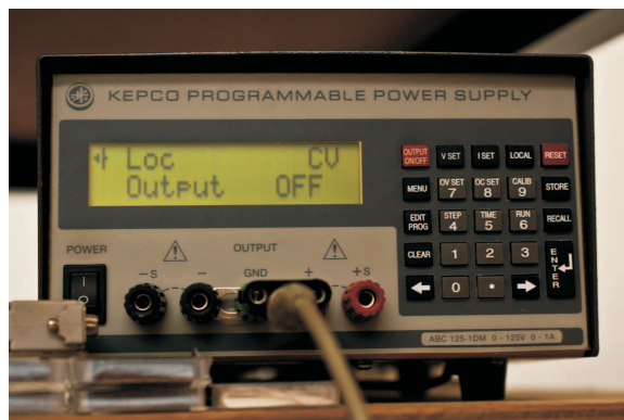
Figura 2.4: Imagen de la fuente de voltaje utilizada Kepeco ® ABC 125-1DM .
