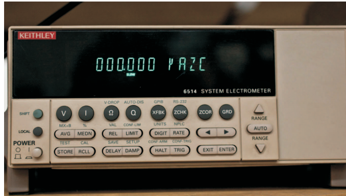
Figura 2.5: Imagen del electrómetro utilizado Keithley ® 6514.
