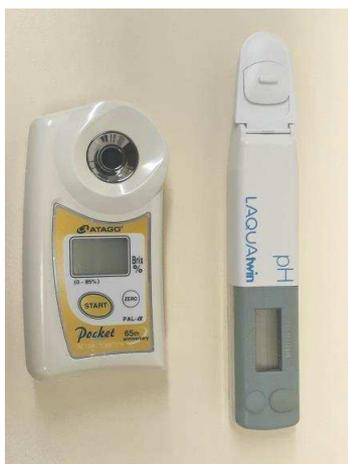
**Figura 2.5** Refractómetro Atago y pHmetro Horiba
