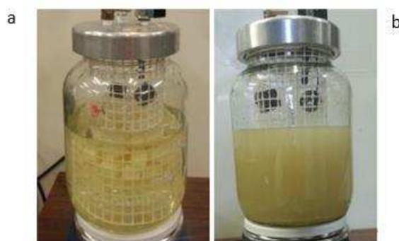
**Figura 3.3** Impregnación de manzanas variedad Granny Smith con distintas presiones de vacío
