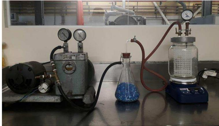
**Figura 2.2** Sistema de Impregnación por vacío.
