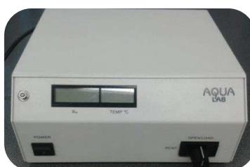
**Figura 2.6** Medidor de  $a_w$  Aqualab
