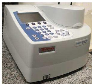
**Figura 2.21** Espectrofotómetro Génesis 10S UV-VIS Thermo Scientific
