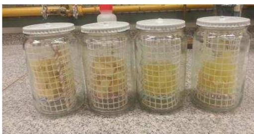
**Figura 2.11** Frascos con muestra para medición de tasa de respiración.
