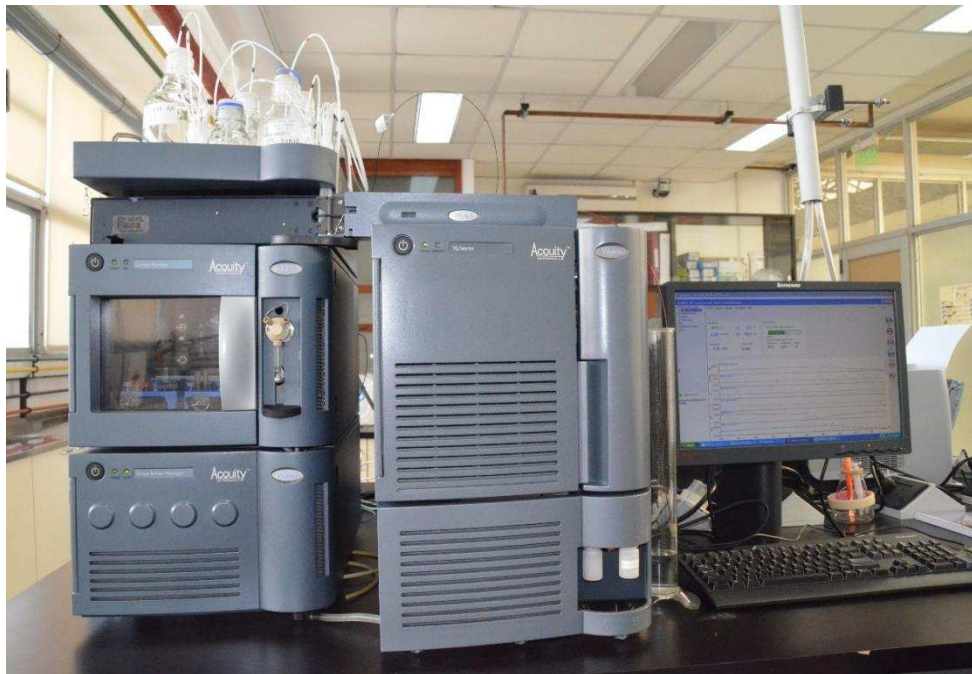
Figura 8. Equipo de cromatografía líquida acoplado a espectrometría de masa con analizador de triple cuadrupolo (UHPLC-MS/MS) utilizado durante este trabajo. PRINARC, FIQ, UNL.
