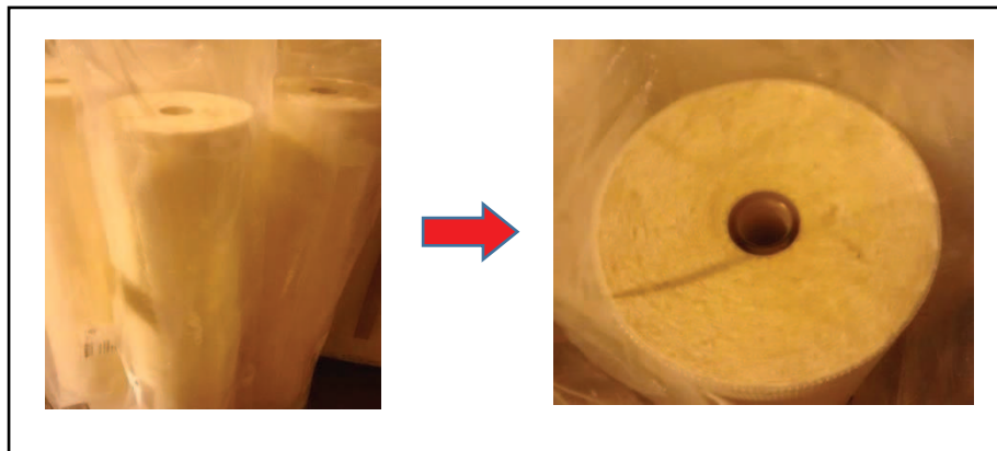
Figura 13. Membrana de nanofiltración
