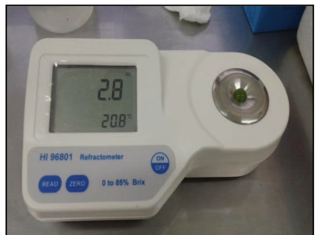
Refractómetro para la determinación de °Brix
