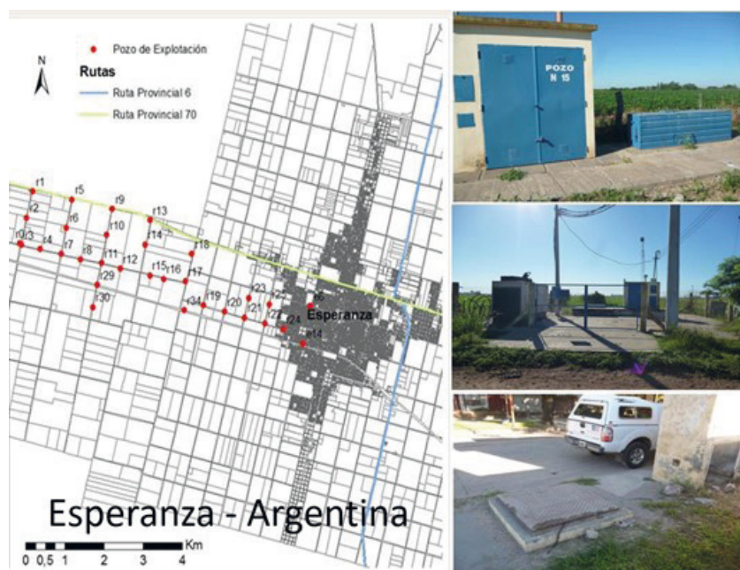
Figura 13.20. Campo de bombeo del sistema de abastecimiento de agua potable para las localidades de Esperanza y Rafaela (distrito Esperanza, Santa Fe)
