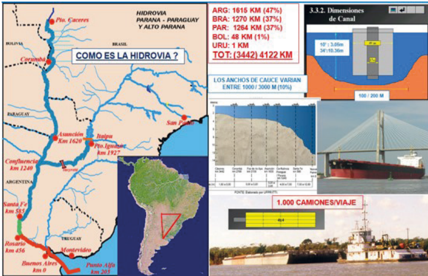
Figura 16.3.2. Tramos, profundidades y embarcaciones de la hidrovía
