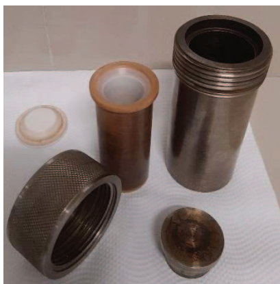
Figura 1. Autoclave utilizada en la síntesis de MOFs por calentamiento en estufa.
