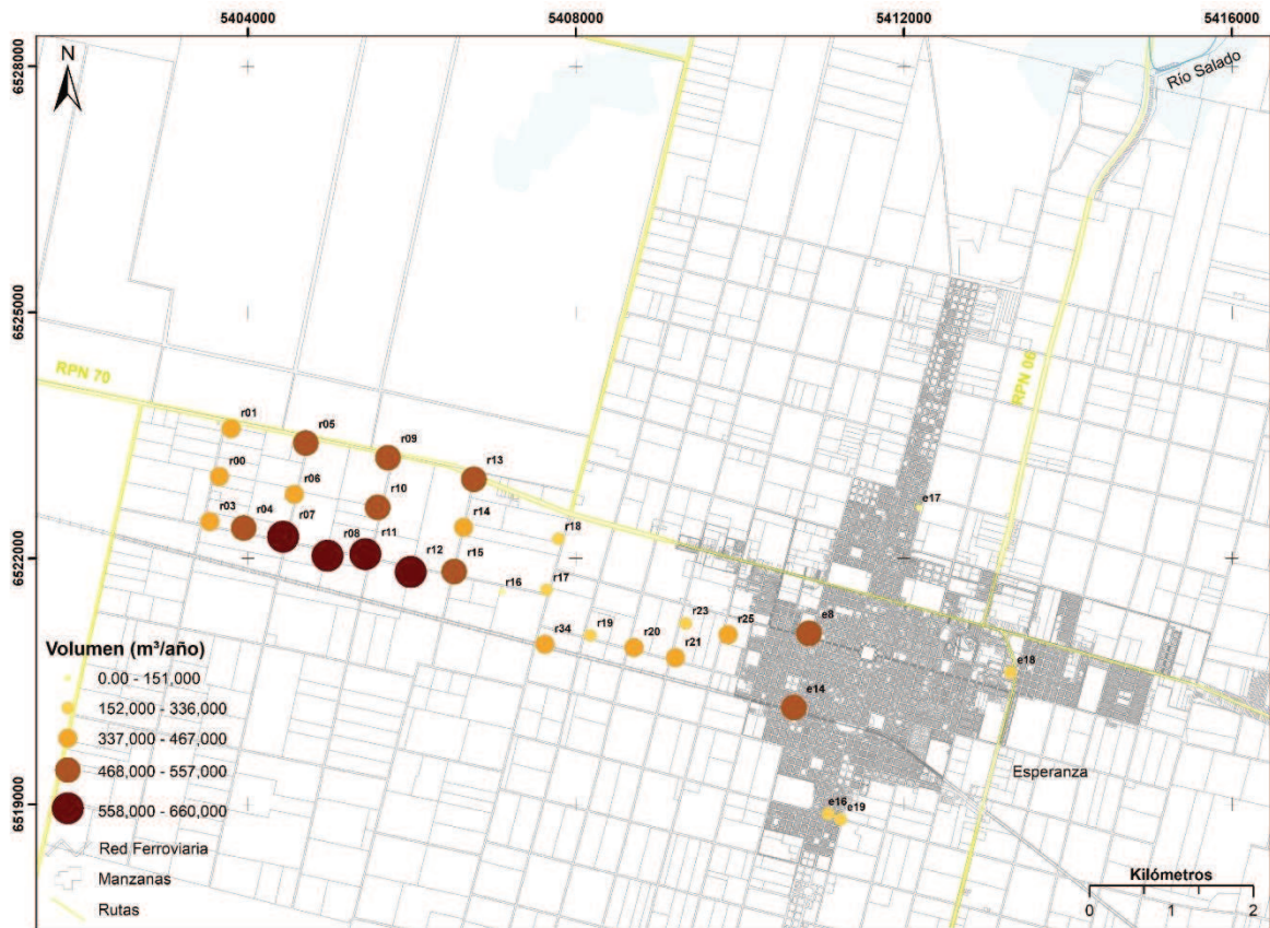
Figura 44. Pozos de bombeo destinados al abastecimiento público.
