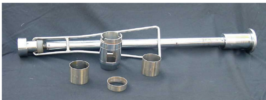
FIGURA 4.13. EQUIPO PARA EXTRAER MUESTRAS NO DESMENUZADAS DENTRO DE CILINDROS. SE APRECIA LA VARA CON PESA PARA GOLPEAR E INSERTAR EN EL SUELO LA CAMISA CON FILO QUE CONTIENE Y PROTEGE EL CILINDRO DONDE SE ALOJA EL SUELO SIN MODIFICAR SU ESTRUCTURA
