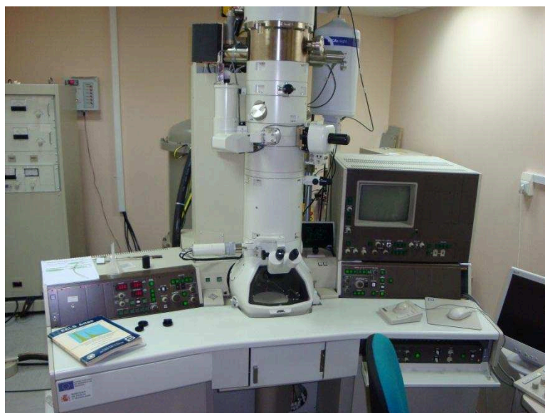
Figura 1.1. Microscopio Electrónico de Transmisión de 200 KV, JEOL-2010F.
