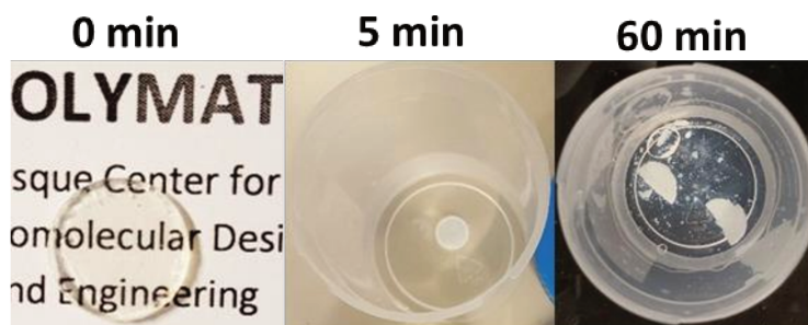
Figura 4.2. Fotografías de la película de CN-OA/IBOMA, durante el ensayo de resistencia a la inmersión en agua.
