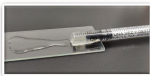
Figura 3.5. Fotografía del producto de reacción, empleando zeína nativa como agente entrecruzante ( V_{40}ZN_{10} ).
