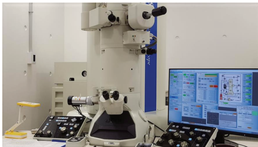
Figura A.11. Equipo JEOL JEM-2100 plus perteneciente al SECEGRIN del CCT-Santa Fe empleado en la determinación de la morfología de las partículas.
