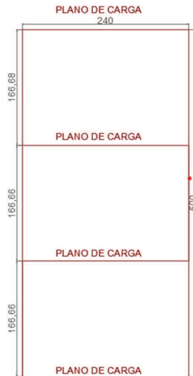
Ilustración 4: Propuesta nuevos racks de almacenamiento. Fuente: Elaboración propia en base a catálogo de empresa Mecalux.
