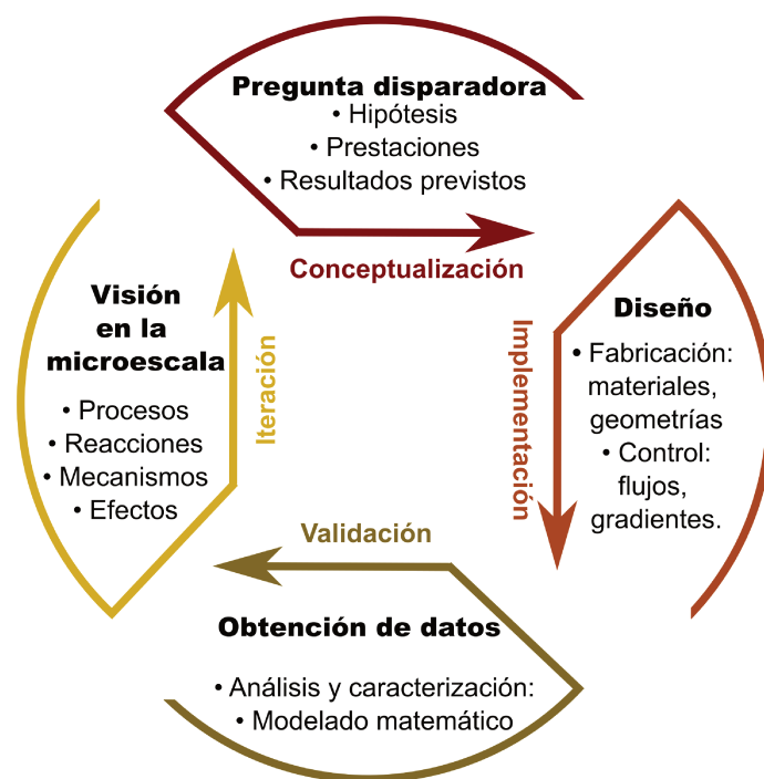
Figura 5: Esquema representativo del desarrollo de un dispositivo LOC a partir de la información reportada en Zhu et al. (2022).
