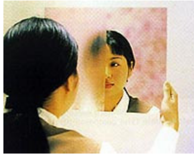
Figura I.5: Espejo antiniebla recubierto con \text{TiO}_2 (a la derecha). (Fujishima et al., 1999).
