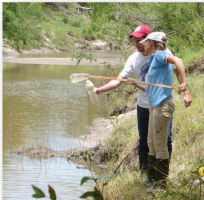
Figura 17. Toma de muestra de agua con muestreador manual
