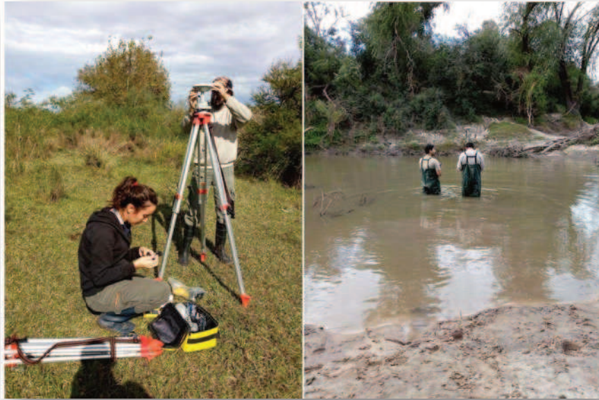
Figura 10. Mediciones con GPS geodésico para determinar las secciones transversales en los sitios de muestreo
