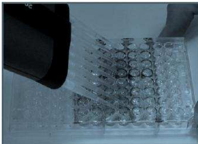
Figura 2. Realización de un ensayo ELISA sobre placa de 96 pocillos (fuente: González y col., 2007).
