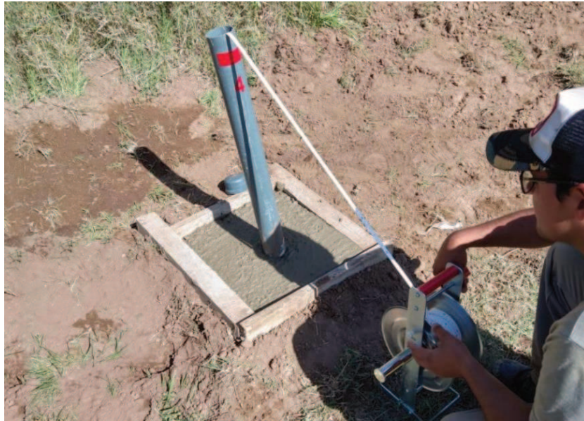
Figura 5: Pozo de observación y sonda para medir el nivel freático.
