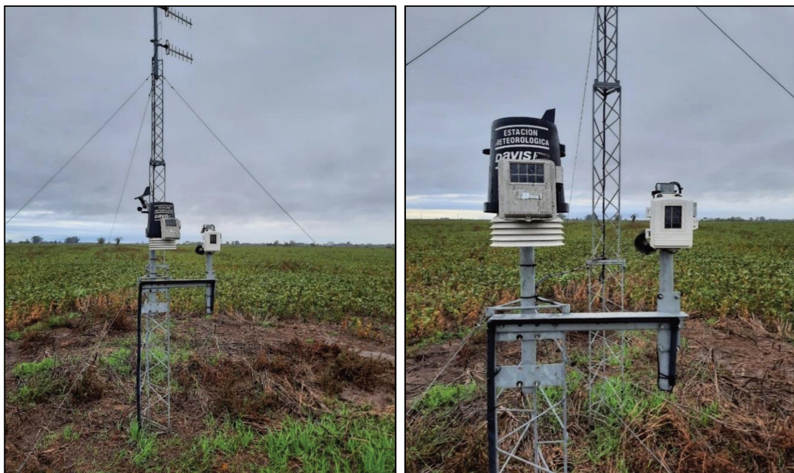
Figura 2: Estación meteorológica automática de la SRSCC.
