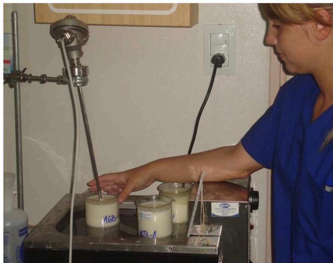
Figura 2.1. Determinación in vitro del tiempo de coagulación
