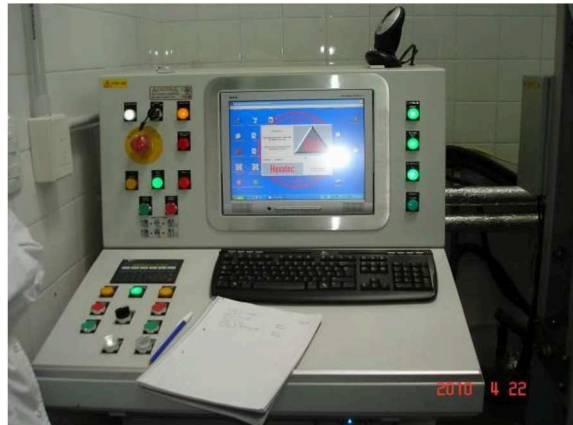
Figura 5. Imagen correspondiente al módulo de control del equipo APH Stansted Fluid Power Ltd. High Pressure Iso-Lab System modelo FPG9400:922.
