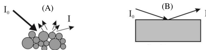
Figura 2.8: Tipos de posibles de reflexión. (A) Reflectancia difusa y (B) reflexión especular
